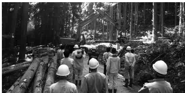
ハーベスタ伐出作業 全幹のまま掴める0.55という大型ベースマシンに、最新のアタッチメント交換システムが付属。油圧ホースを1本ずつ繋ぐなくても半自動で繋いでくれるため、グラブからハーベスタへのアタッチメント交換がスムーズ且つ短時間でした。
