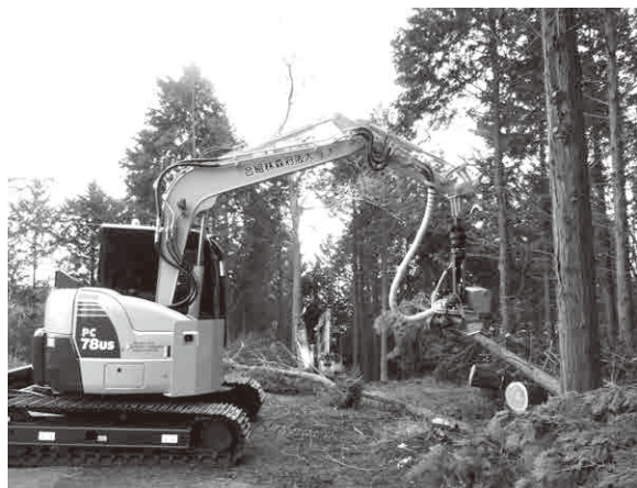
ハーベスタによる造材作業 道があれば高性能林業機械の活躍などにより 搬出作業の低コスト化がすすみます
